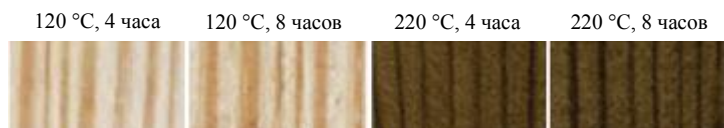
Рис. 1. Образцы древесины сосны обыкновенной при воздействии температуры 120 °С и 220 °С в течение 4 и 8 часов
