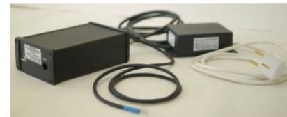
Рис. 3. Внешний вид устройства пассивной технической защиты цифровых телефонных аппаратов
