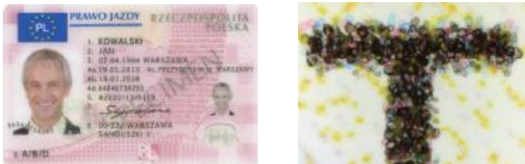
Рис. 4. Водительское удостоверение Республики Польша с фрагментом увеличенного фотоизображения, персонализированное при помощи технологии PCP
