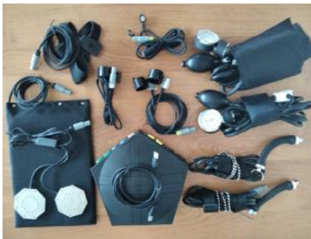
Рис. 9. Одиннадцатиканальный профессиональный компьютерный полиграф AQIQAT
