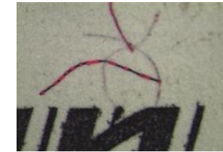
Рис. 7. Пример исследования при помощи микроскопа спектрального люминесцентного цветного защитного волокна, поднятого над поверхностью бумаги банкноты Украины номиналом 1 гривна 1992 года выпуска
