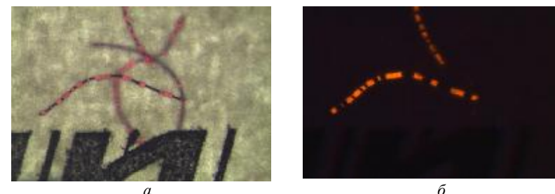
Рис. 5. Фрагмент банкноты России номиналом 100 рублей с бикомпонентными профилированными ступенчатыми волокнами типа «Зона»: a – вид в проходящем свете; б – люминесценция в УФ-излучении
