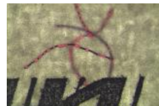
Рис. 7. Пример исследования при помощи микроскопа спектрального люминесцентного цветного защитного волокна, поднятого над поверхностью бумаги банкноты Украины номиналом 1 гривна 1992 года выпуска
