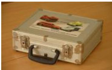
Блок моделей транспортных средств различного вида, предназначенных для дорожного движения, пешеходов, придорожных объектов, используется для моделирования дорожной обстановки на различных стадиях механизма расследуемого ДТП.
